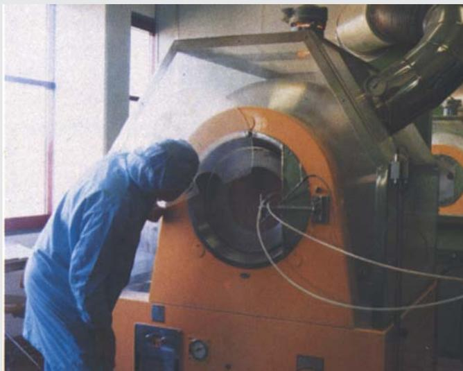
Beschichtungsmaschine für Tabletten
