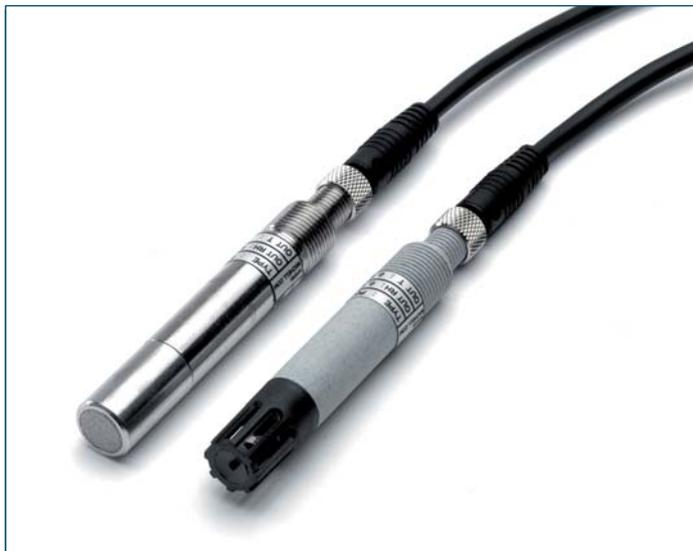
Die Mikroprozessortechnik mit Multi-Punkt-Kalibrierung bietet im PCMini52 Relative Feuchte Transmitter exzellente Leistung in Bezug auf Genauigkeit und Linearität. Der Mini Transmitter im 12 mm Format kann zwei lineare Analogausgänge für Temperatur und relative Feuchte, Taupunkt oder Absolutfeuchte zur Verfügung stellen.
